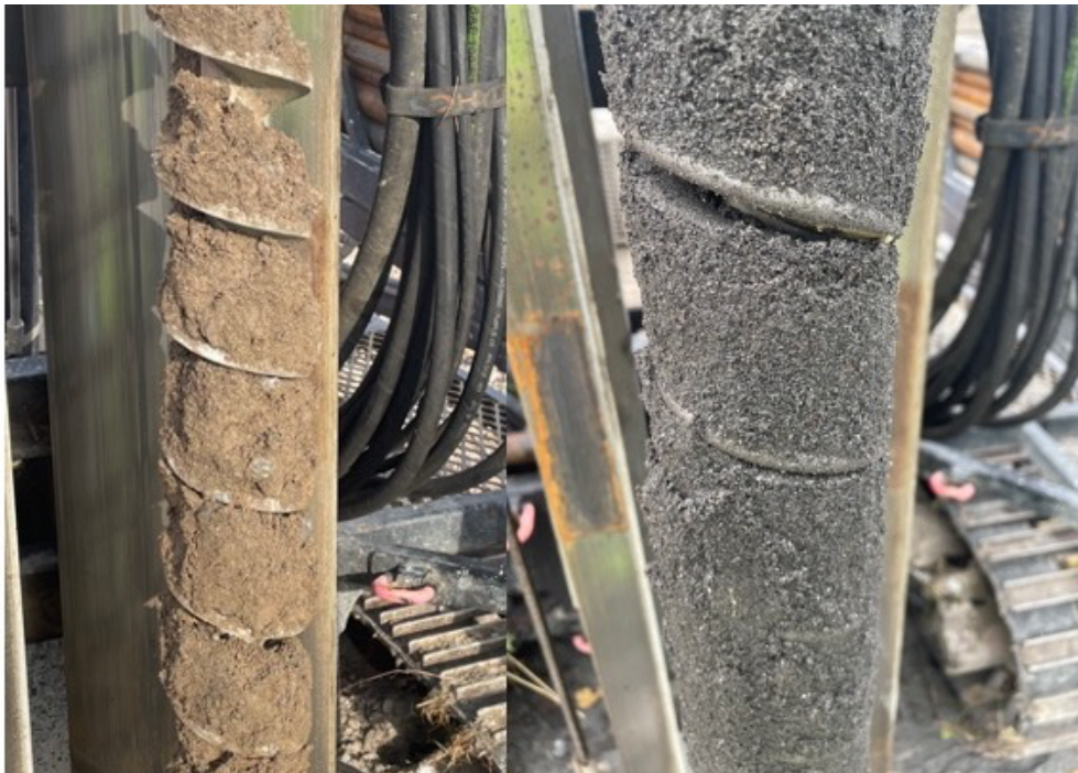
Figur 3 visar jord från markundersökning. Till vänster grusig sandig fyllning, till höger sligsand.
